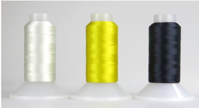
Abb. 1: Gefärbte PET-Nähgarne mit Sicherheitsmarkierung (0,05 Gew.-% LaB<sub>6</sub> Nanopartikel)
